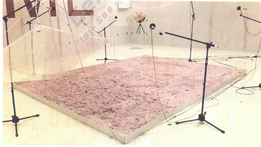
Şekil 2. CelluBOR selüloz yalıtım malzemesinden oluşan ses yutucu yüzey ve mikrofonların çınlanım odası içerisindeki yerleşiminin gösterimi
