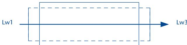
De demping is het verschil tussen het geluidsvermogen Lw1 in het meetkanaal vóór de slang en het geluidsvermogen Lw3 in het meetkanaal ná de slang (gemiddeld over drie meetplaatsen).
