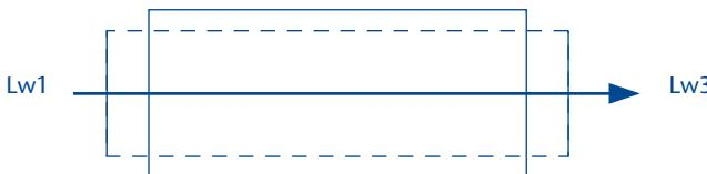
Unter "Dämpfung" versteht man die Differenz zwischen dem Schalleistungspegel Lw 1 im Prüfkanal vor dem flexiblen Schlauch (gemittelt über drei Meßstellen) und den Schalleistungspegel Lw 3 im Prüfkanal hinter dem flexiblen Schlauch.
