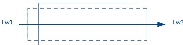
La amortiguación es la diferencia entre el nivel de ruido Lw1 en el conducto de medición de delante del tubo y el nivel de ruido Lw3 en el conducto de medición tras el tubo (nivel de ruido medio de tres lugares de medición).
